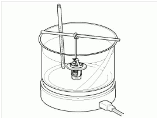
2. 检查阀门打开时的温度。
